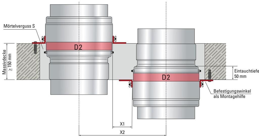
\* Deckeneinbau: Befestigungswinkel (hier rot) bei Einbau auf der Decke jeweils Oberkante Decke bündig montieren,
