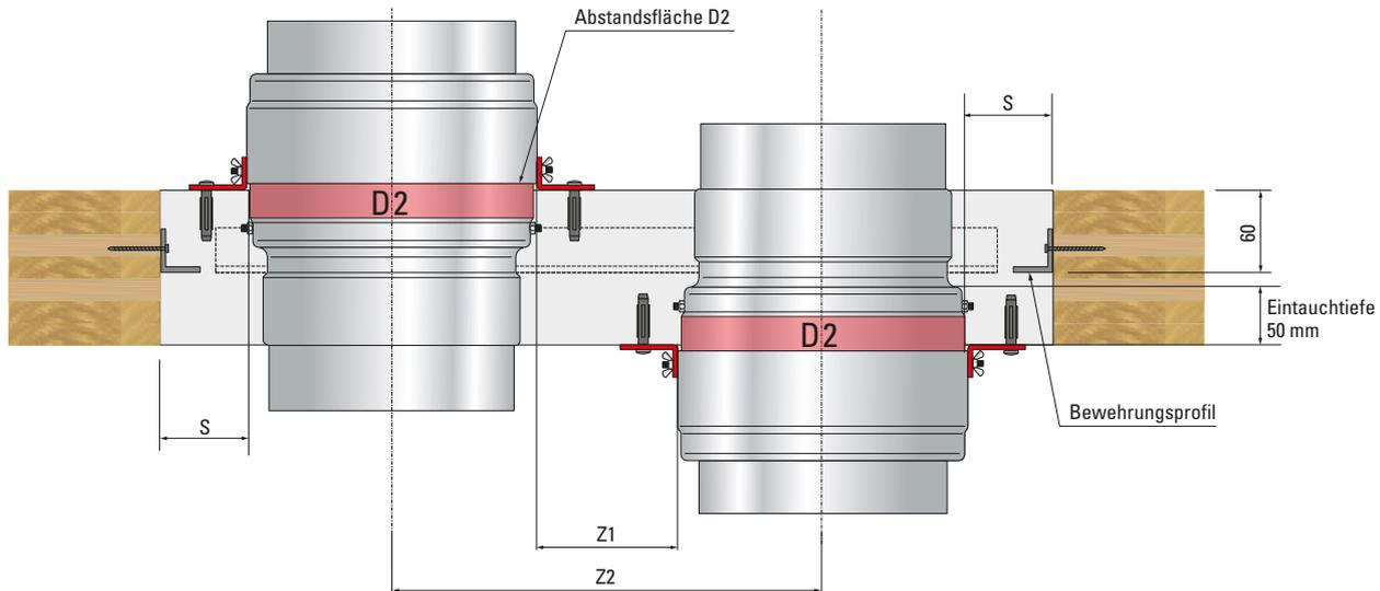
Holzdeckeneinbau: Bewehrungsprofil in 60 mm Tiefe umlaufend in den Deckendurchbruch befestigen
