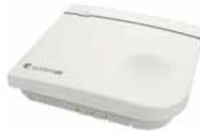
Funk-CO<sub>2</sub>-Sensor zur bedarfsabhängigen Steuerung der Wohnungslüftungsgeräte. Messbereich 400 bis 2000 ppm. Betrieb nur in Kombination mit dem Funk-Sender/Empfänger RS485 möglich.
