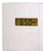
Messsystem mit CO<sub>2</sub>-Fühler. Die CO<sub>2</sub>-Konzentration wird mit Hilfe eines Infrarotlichts gemessen. Mit dieser Technik wird die Absorption der Gase gemessen.
