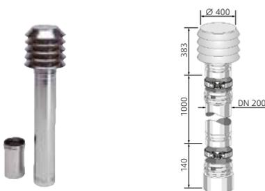
Hergestellt aus Edelstahl. Besteht aus einer Lamellenhaube (Lieferung inkl.), einem 1.000 mm langen Rohr, zwei statischen Schellen und einem Adapter für DN 200 Rohranschluss. Die Ansaugung sollte mind. 100 cm über dem Erdrich erfolgen. Die Haube des Lufteinlasses ist abnehmbar, um den innenliegenden Filter zu reinigen oder zu wechseln.
