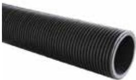
Schallabsorbierendes, robustes Rohr vorzugsweise für den Einsatz in unbeheizten Bereichen. Außenmantel aus Polyethylen mit hoher Dichte (HDPE); Innenmantel aus Polyolefin mit geschlossener Zellstruktur.
